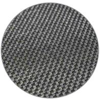
Es un material hecho de poliéster (resina) recubierto de PVC (cloruro de polivinilo). Esta combinación le confiere gran resistencia a factores ambientales como rayos UV, agua y moho, haciéndolo ideal para muebles de exterior y otras aplicaciones al aire libre.
